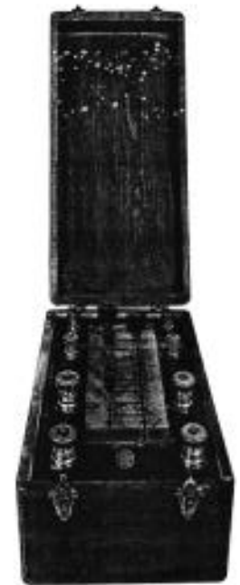
Figura 8. Puente de Wheatstone, Facultad de Física. Núm. inv. F-0073. Universitat de València.
