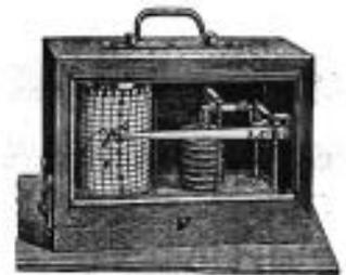
Barógrafo. La pieza sensible a la presión está formada por varias cajas del barómetro Vidi superpuestas. Los movimientos que los cambios de presión producen en estas cajas se recogen a través de la aguja y se transmiten al extremo donde hay una pluma constantemente entintada, apoyada sobre la hoja de papel cuadrículado. Imagen procedente del González Martí, *Tratado de Física General*. Imprenta Hijos M.G. Hernández, Madrid, 1904.
