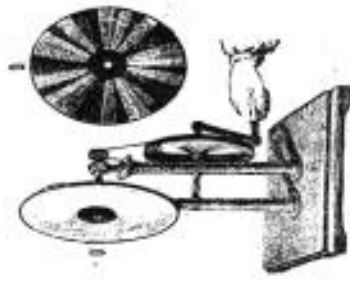
Los imágenes del disco de colores de Newton, al que imprimíndole un rápido movimiento de rotación, se observa el color blanco.
